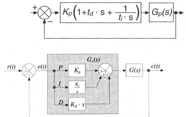
Diagrama de bloques de un controlador PID
