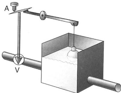
Si se produce un aumento del caudal de salida, disminuye el nivel del depósito, entonces el flotador, a través de un brazo, actúa sobre la válvula V, haciendo aumentar el caudal de entrada hasta que se iguale al siguiente. Cuando se haya alcanzado la igualdad de los caudales, el flotador estará a un nivel más bajo que al principio, por lo que se produce un error permanente.
