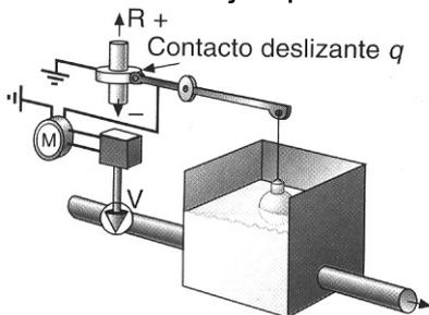
Siguiendo con el ejemplo anterior, en este caso la válvula de regulación está accionada por un motor de c.c. que gira proporcionalmente a la tensión aplicada, por lo que la separación del contacto deslizante q de la posición del cero de tensión, determina apertura o cierre de la válvula con velocidad proporcional a la separación que se produzca, es decir, a la variación que experimenta el flotador del punto de ajuste y durante el tiempo que exista la variación.
