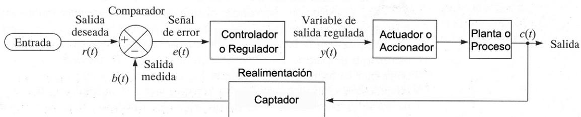
La salida del sistema de regulación se realimenta mediante un captador. En el comparador o detector de error, la señal de referencia (salida del transductor) se compara con la señal de salida medida por el captador, con lo que se genera la siguiente señal de error:
