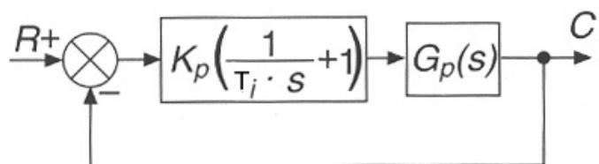
Como se observa en la figura, la respuesta del controlador PI es la suma de las respuestas de un controlador proporcional y un controlador integral lo que proporciona una respuesta instantánea al producirse la correspondiente señal de error provocada por el control proporcional y un posterior control integral que se encargará de extinguir totalmente la señal de error.
