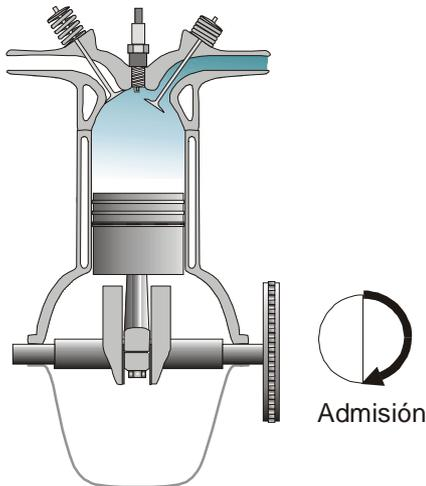
**a ⇒ b Admisión:** la válvula de admisión se abre y el pistón se desplaza en retroceso al PMI (punto muerto inferior), llenándose de aire y combustible (según el tipo Diesel u Otto), que entra en el cilindro a la presión atmosférica. El pistón realiza una carrera desde el PMS al PMI, mientras el cigüeñal da media vuelta.
